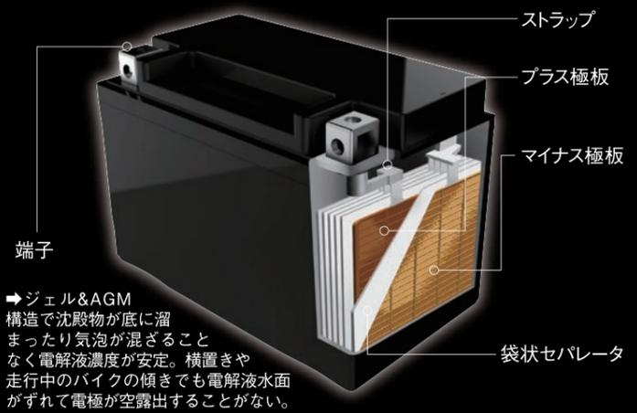
→ジェル&AGM構造で沈殿物が底に溜まったり気泡が混ざることなく電解液濃度が安定。横置きや走行中のバイクの傾きでも電解液水面がずれて電極が空露することがない。
